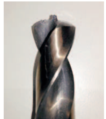
Fig. 8 Dynamisches Auswiegen: angefertigter HSS-Bohrer zum Anbohren der ersten Position.
