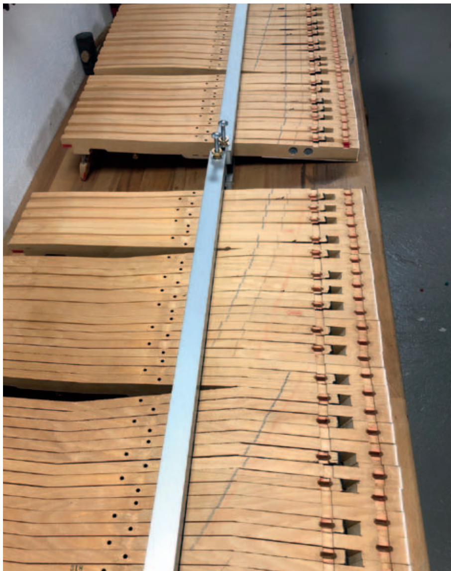
Fig. 9 Das Auswiegen nach Linien, hier eine Yamaha-Klaviatur von 1975. Weighting following a line – a Yamaha keyboard from 1975. Pesée d'après des lignes (clavier Yamaha de 1875).
