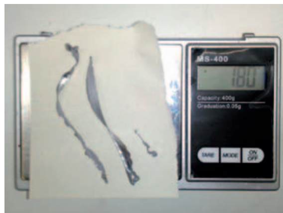
Fig. 7 Dynamisches Auswiegen: Gewicht der von der ersten Position abgebohrten Späne. Dynamic weighting: weight of lead shavings from drilling first position. Pesée dynamique : pesée du copeau enlevé au premier plomb.
