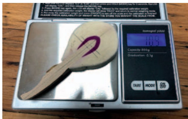
Fig. 2 Gewicht eines modernen Steinway-Basshammers Nr. 1, im Vergleich deutlich schwerer. The weight of a modern Steinway bass hammer no. 1, considerably heavier in comparison. Poids d'un marteau de basse Steinway moderne No 1, nettement plus lourd.
