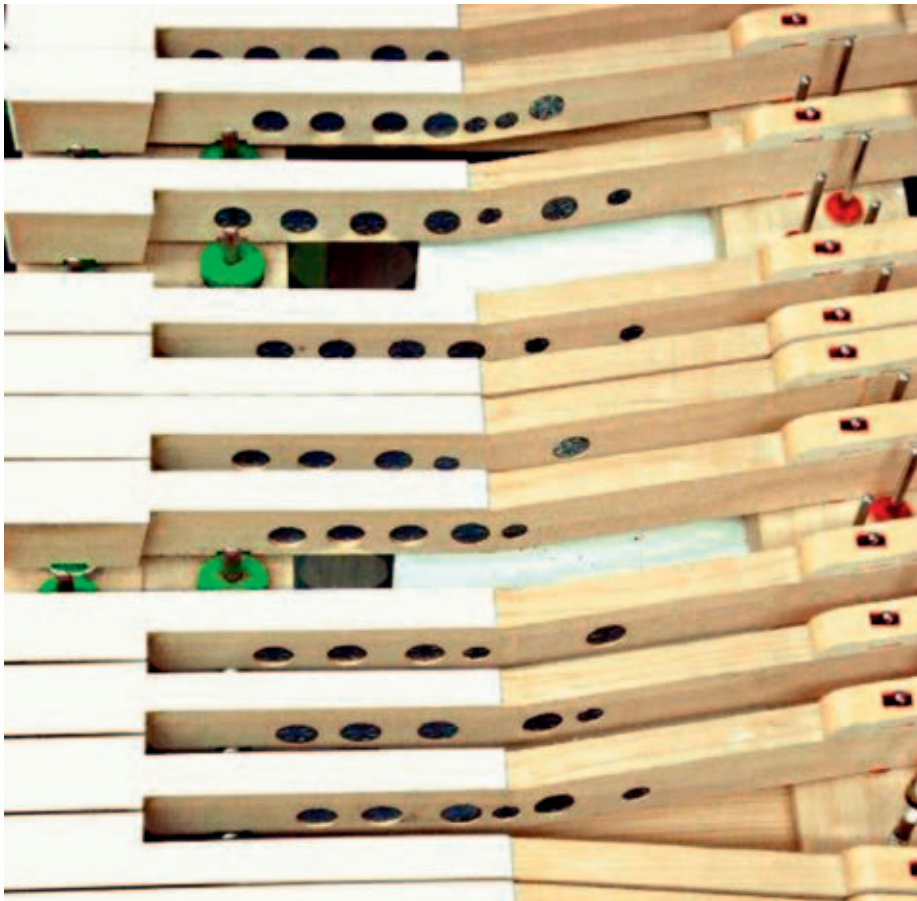
Fig. 5 Fragwürdige Auswiegung. Questionable weighting. Pesée problématique.
