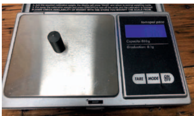
Fig. 11 Für die bleifreie Klaviatur verwendete Wolframierte: fast gleiches Volumen wie zwei 8-er Bleinieten, dabei 2,5 Gramm schwerer. Wolfram weight for lead-free keys: almost the same volume as two no.8 lead weights, but 2.5g heavier. Plomb en tungstène pour le clavier sans plomb : volume similaire à celui de deux plombs de 8, plus lourd de 2,5 g.
