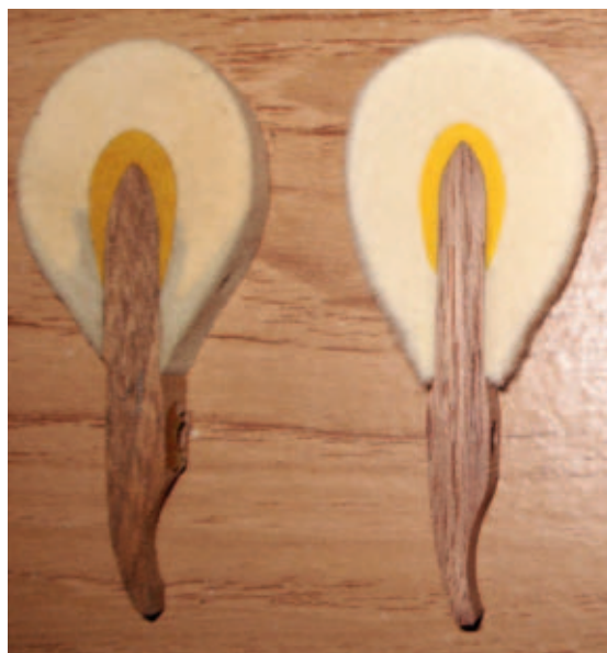
Fig. 3 Formen neuer Hammerköpfe nach originalem Muster mit dem Ziel, annähernd das Gewicht der Originale zu erreichen.
